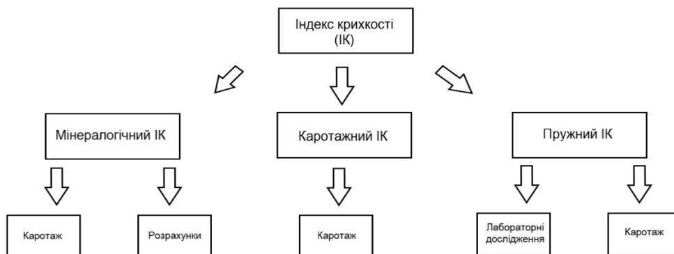
Рис. 2. Класифікація підходів до визначення індексу крихкості (модифіковано за Mews et al., 2019)
