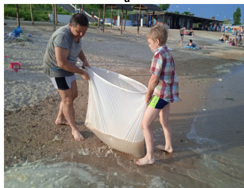
Рис. 5. Процес відбору проб зі зворотних хвильових потоків (а) та подальшої сепарації (б) через фільтрувальну тканину
