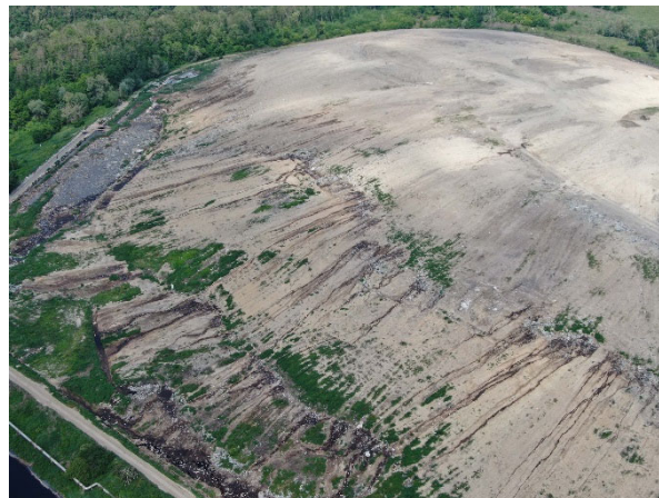
Рис. 2. Перспективне дистанційне зображення північно-західної частини Київського полігону захоронення ТПВ № 5, зроблене з безпілотного літального апарата 31.05.2019 р., на якому простежуються місця височування фільтрату (чорно-коричневий копір) з "тіла" сміттєзвалища (карта "А"), стікання його по схилу і накопичення у його підніжжі
