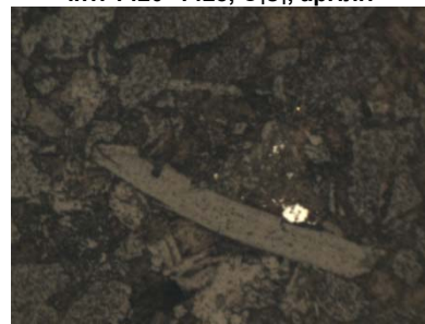
Рис. 10. Детриніт, гематит. Аншліф ЛІВ-8, св. Ливенська-1, інт. 1720–1728, C_{1V_1} , пісковик
