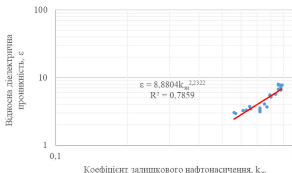
Рис. 9. Кореляційна залежність між коефіцієнтом залишкового нафтонасичення ( k_{зн} ) і відносною діелектричною проникністю ( \epsilon ) вапняків, насичених газом
