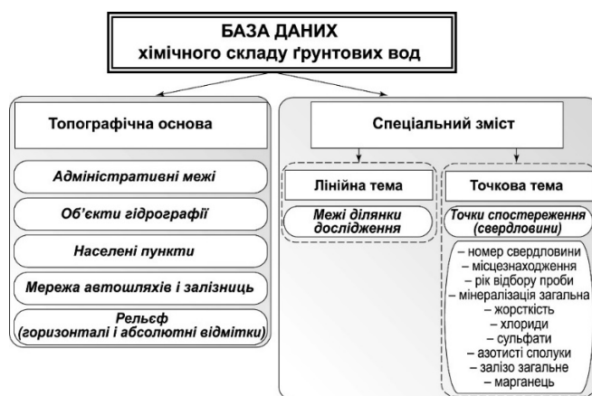
Рис. 1. Функціональна модель спеціалізованої бази даних хімічного складу ґрунтових вод
