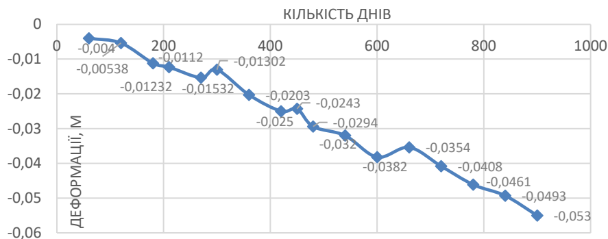
Рис. 4. Графік вертикальних зміщень зсувонебезпечної ділянки в межах с. Голубине (48°34'49.2"N 22°58'13.7"E)
