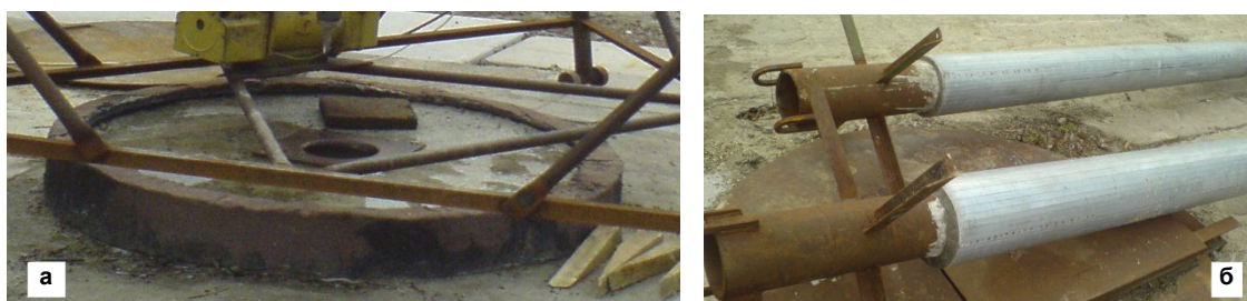
Рис. 1. а – модель карбонатного пласта, \delta_{в.п.} = 2,45 \text{ г/см}^3 , k_p = 20 \% ; б – імітатори обсаджених колон із цементним кільцем для калібрування приладів WL-РК
