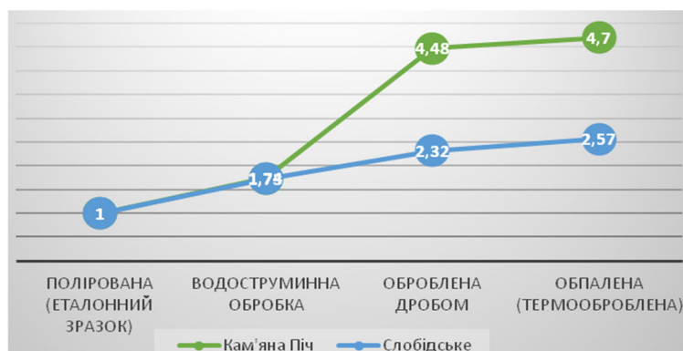
Рис. 1. Зростання показника водопоглинання (вісь Y) лабрадоритів родовищ Кам'яна Піч і Слобідське відносно еталонного зразка залежно від типу обробки поверхні (вісь X)
