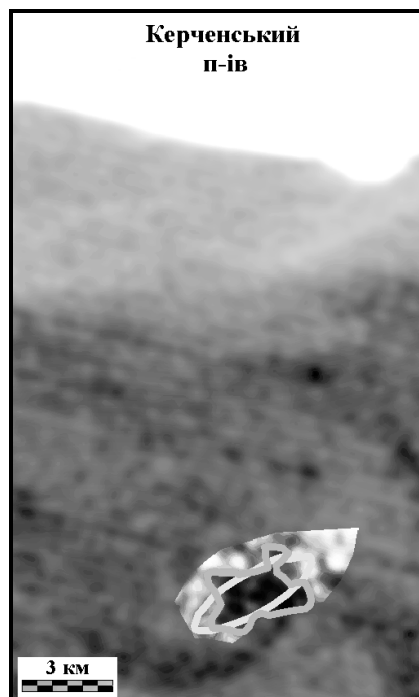
Рис. 2. Співставлення виділеної теплової аномалії (темно-сірий колір) на комп'ютерно обробленому космічному знімку Landsat TM (05.05.1992 р., 6-ий канал, діапазон 10,4–12,5 мкм) із контуром локального склепіння Керченської структури (світло-сірий колір, горизонт відбиття ІІа – нижня частина відкладів майкопської світи)
