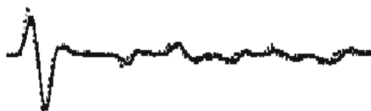
Рис. 3. Накладання синтетичних сейсмограм отриманих рефлексивним та FCT методами для моделі середовища із табл. 1 та із використанням часової функції у вогнищі (16) [ 18]
