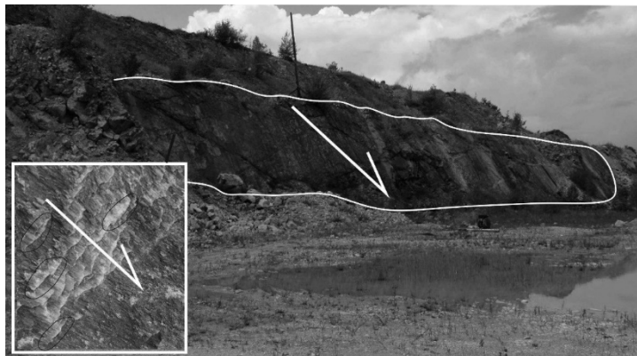
Рис. 8. Велике тектонічне дзеркало з борознами ковзання, що вказують на скидово-зсувне переміщення в полі ПдЗ-ПнС розтягу: Приборжавський кар'єр (відслонення 5)
