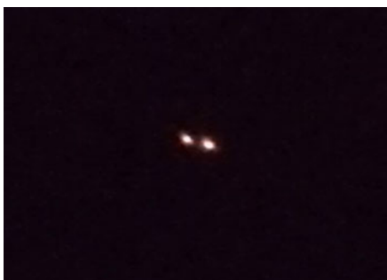
Рис. 2. Іскріння кварцових пісковикових штурфів у процесі зсувної деформації
