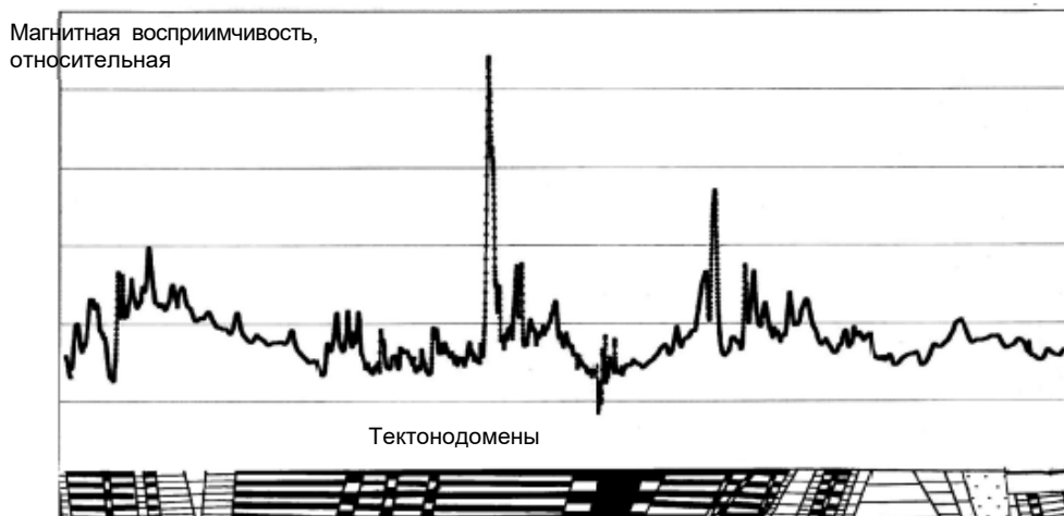
Рис. 2. Пример реститового магнетизма почвенного покрова при картировании кристаллического фундамента и рудных минералов на примере площади "Хщеватое – Завалье". (Основа рисунка взята из монографии [1])
