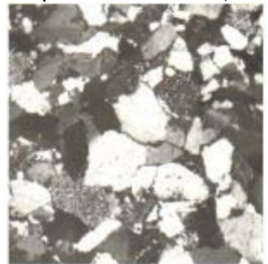
Рис. 5. Пісковик кварцовий, дрібнозернистий. Конформні структури на контактах зерен кварцу. Свердловина 4-Новосхідниця. Інтервал 1951–1953 м. Нік. II, \times 50
