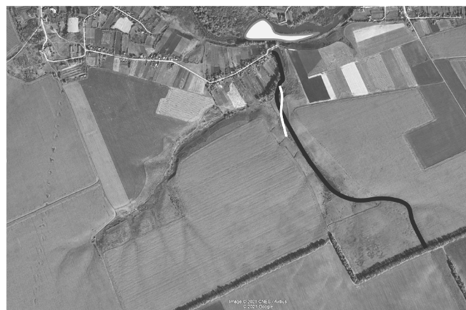
Рис. 3. Найбільша яружна система в центральній частині Іллінецької структури. Білим кольором показано тальвег яру у 1984 р., чорним – те саме розгалуження у 2020 р., сіра ділянка – площа наміву осадового матеріалу з яру у заплаві р. Соб
