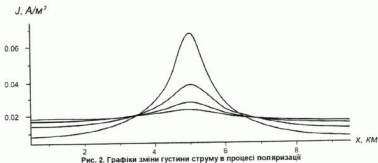
Рис. 2. Графіки зміни густини струму в процесі поляризації
