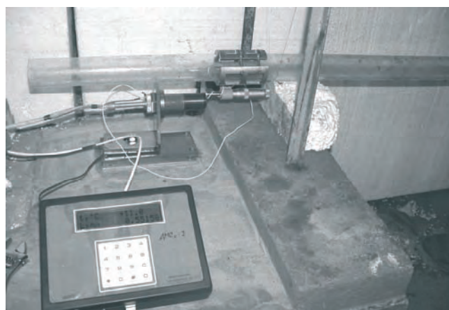
Рис. 2. Вимірювальний блок деформометричної системи з ємнісним датчиком на "короткому" ( L=6,5 м, аз. 52^{\circ} ) деформографі в штольні РГС "Берегове" (а) та апаратура геотермічного моніторингу для РГС "Берегове" з кварцовим геотемпературним датчиком (структурно-функціональна блок-схема)
