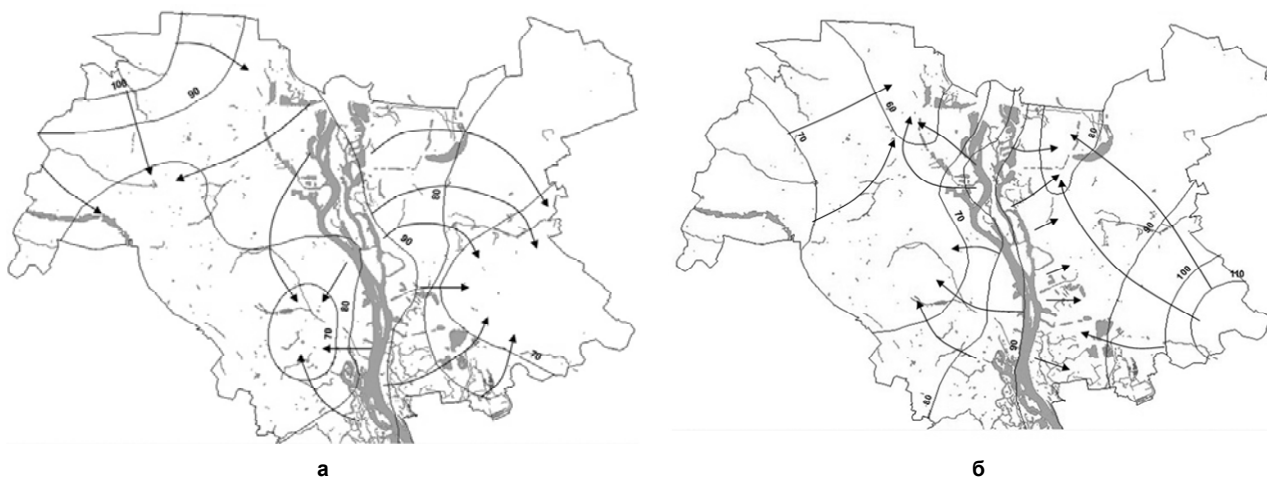
Рис. 1. Схематичні карти п'єзоізогіпс сеноман-келовейського водоносного комплексу (стрілками показано напрямок руху потоку підземних вод): а – станом на 1960 р, б – станом на 2005 р
