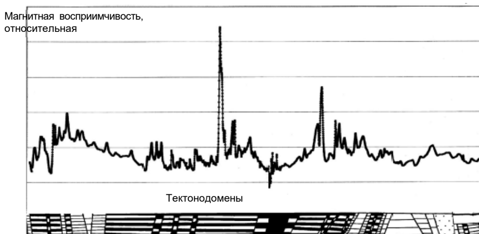
Рис. 2. Пример реститового магнетизма почвенного покрова при картировании кристаллического фундамента и рудных минералов на примере площади "Хашеватое – Завалье". (Основа рисунка взята из монографии [1])
