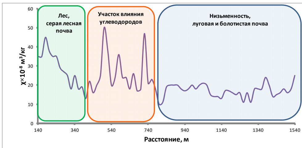
Рис. 3. Пример использования магнетизма почвенного покрова при картировании территории отложений углеводородов вдоль профиля MAG1 полигона "Старуня"
