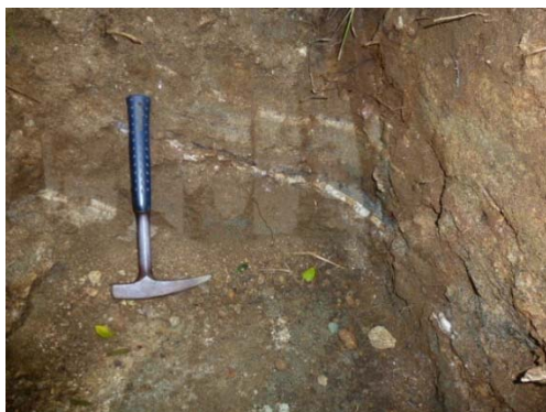
Рис. 3. Система пологопадающих послойных кварцевых прожилков в канаве Т-2
