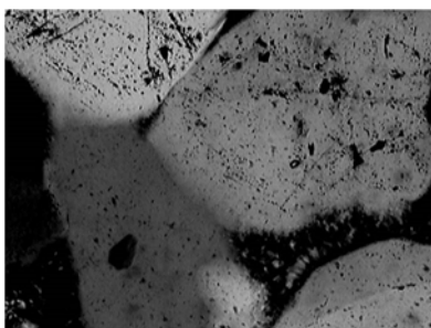
Мономінеральний пісковик окварцований, рівномірнозернистий. Розмір зерен 0,2–0,4 мм, зб. 100×
