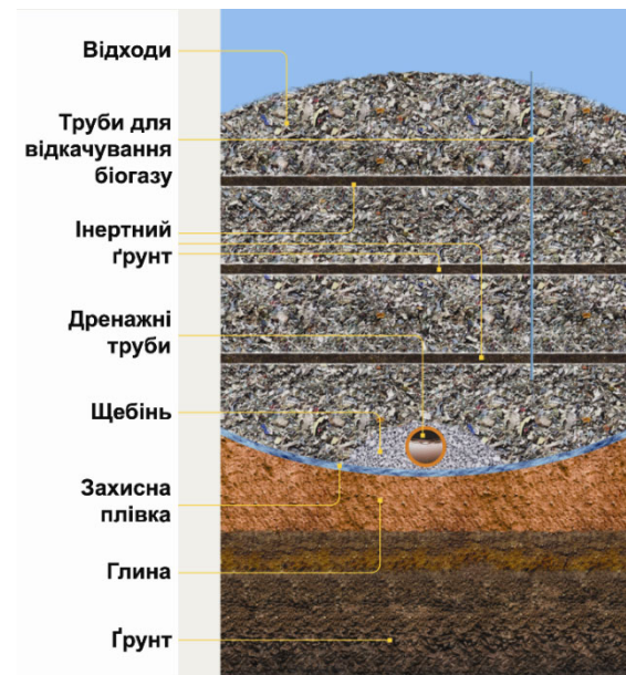
Рис. 3. Принциповий схематичний розріз карти полігону захоронення ТПВ
