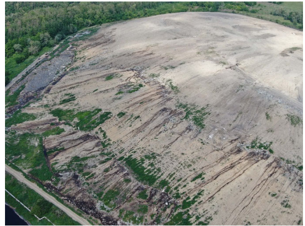
Рис. 2. Перспективне дистанційне зображення північно-західної частини Київського полігону захоронення ТПВ № 5, зроблене з безпілотного літального апарата 31.05.2019 р., на якому простежуються місця височування фільтрату (чорно-коричневий колір) з "тіла" сміттєзвалища (карта "А"), стікання його по схилу і накопичення у його підніжжі
