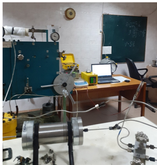
Рис. 1. Загальний вигляд установки для фізичного моделювання пластових умов ВСЦ-1000М
